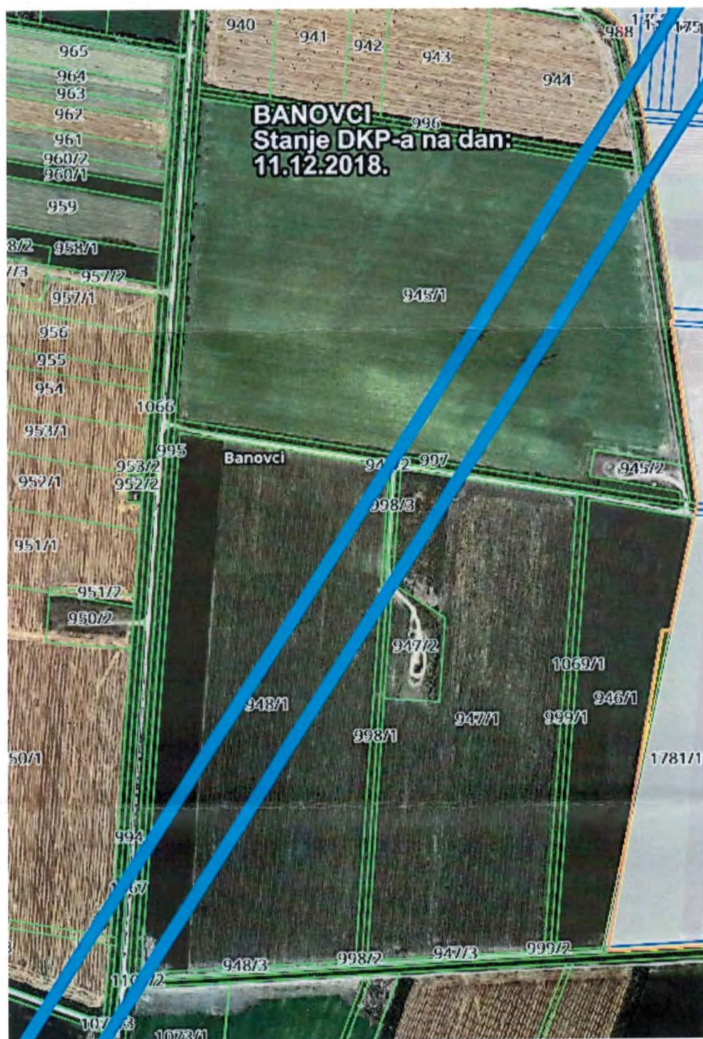
Prilog 2: katastarska situacija trasa nadzemnih vodova DV 110 kV Vukovar-Nijemci i DV 110 kV Nijemci-Šid
