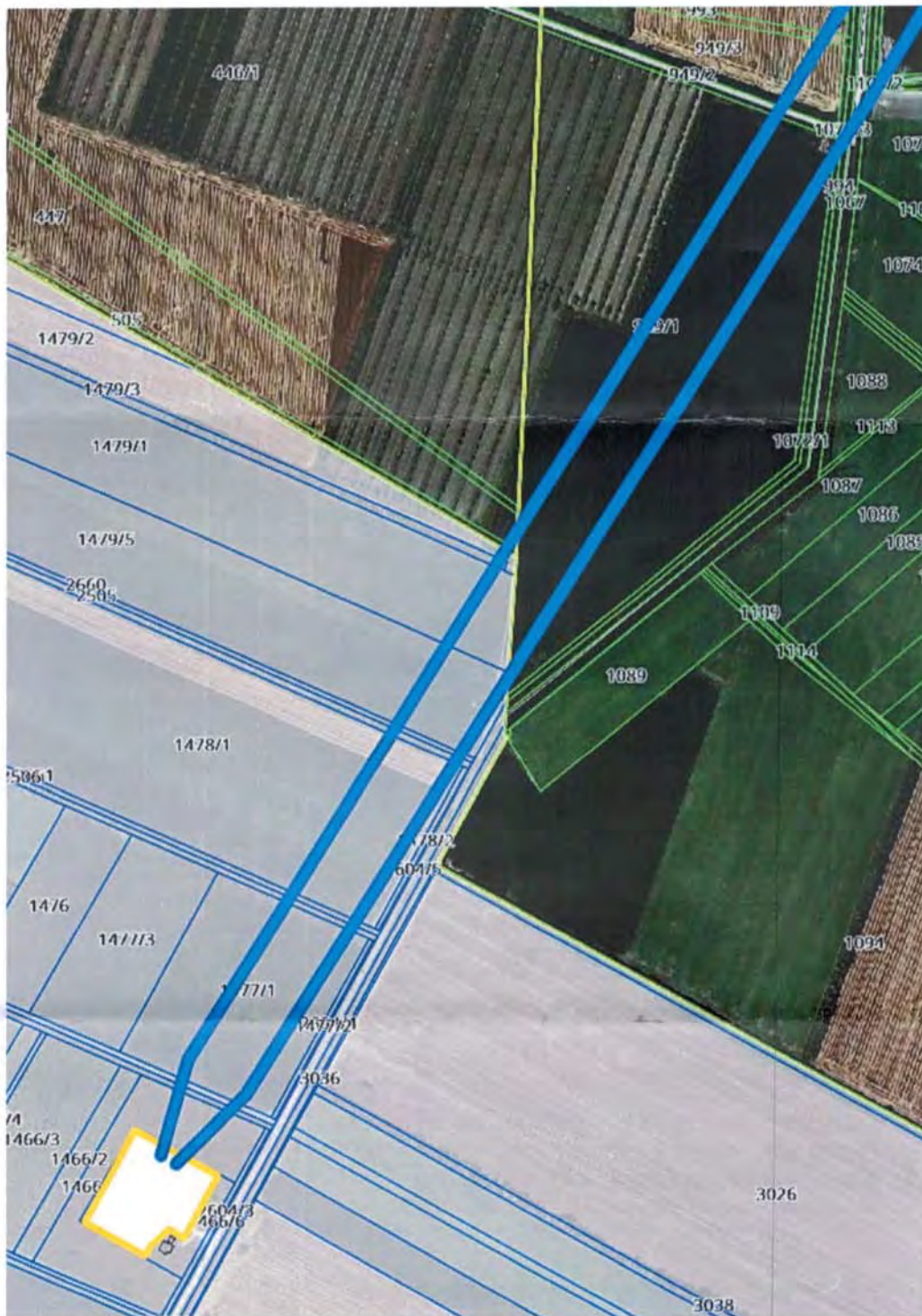
Prilog 1: katastarska situacija TS 110/35/10 kV Nijemci i trasa nadzemnih vodova DV 110 kV Vukovar-Nijemci i DV 110 kV Nijemci-Šid
